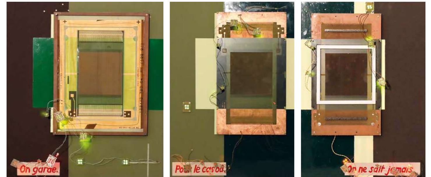
On garde - Pour le cas où - On ne sait jamais. Électrode de prototype d'étude de détecteur gazeux Micromégas.
